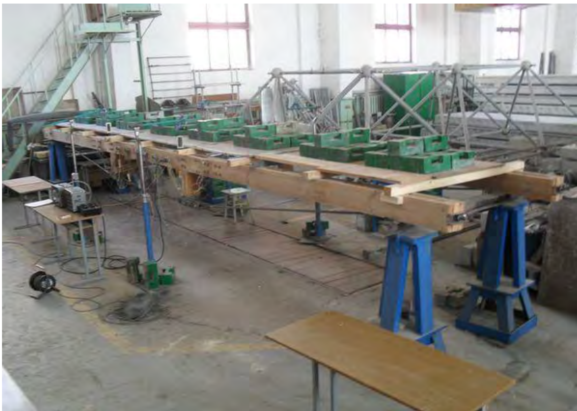
Рис. 1. Блок из двух металлодеревянных ферм на испытаниях
