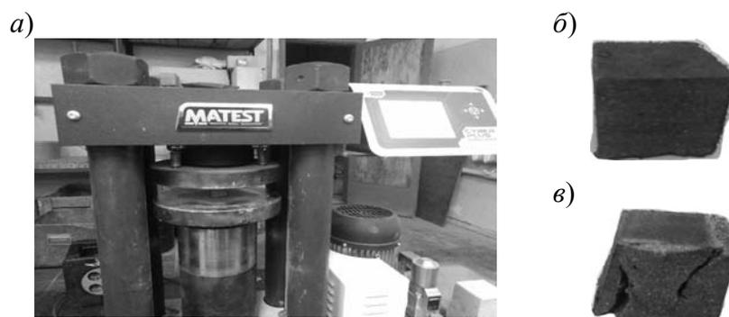
Рис. 2. Испытание материала: *a* – оборудование для испытания; *б* – кубик до испытания; *в* – кубик после испытания
