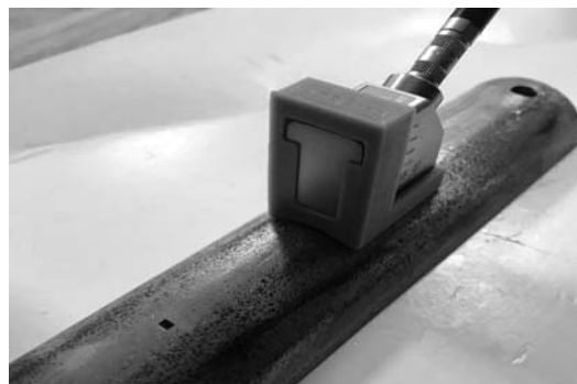
Рис. 2. Настройка ПЭП на трубном образце с зарубкой
