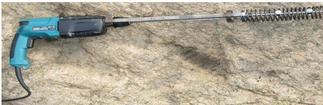
Рис. 2. Экспериментальный пружинный виброуплотнитель
