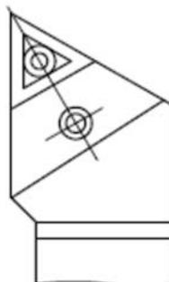
Рисунок 1.9 – Рабочая часть резца
