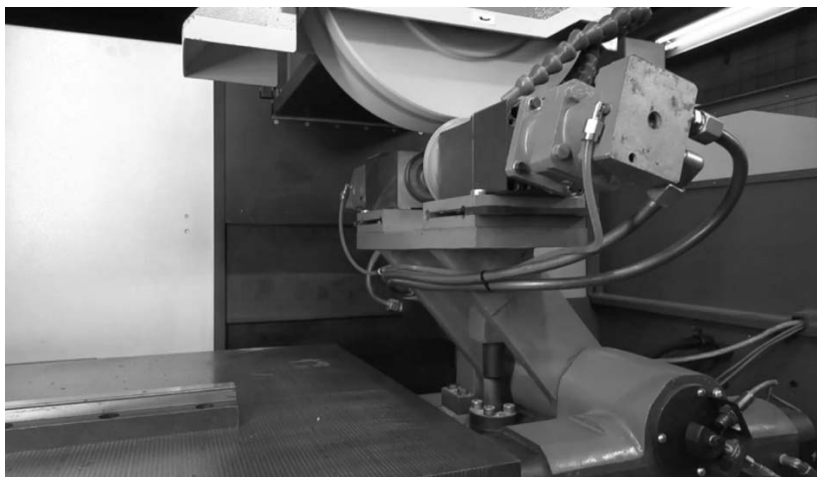
Рисунок 5.5 – Профилирование шлифовального круга
