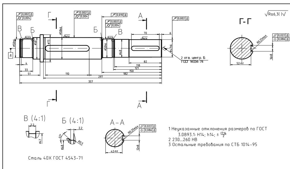
Рисунок 1.3 – Чертеж детали после выполнения мероприятий по повышению технологичности
