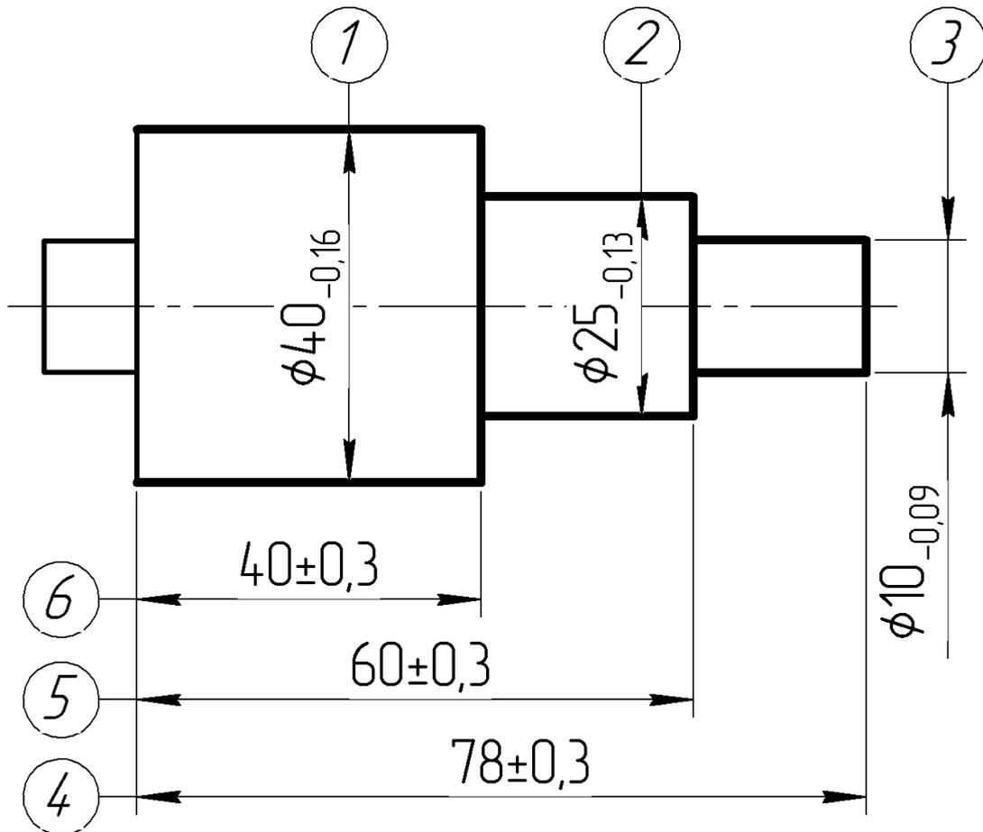
Рисунок 4.1 – Пример обозначения размеров обрабатываемых поверхностей
