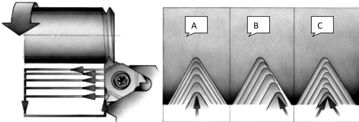
Рисунок 6.1 – Способы врезания при обработке резьбы резцом
