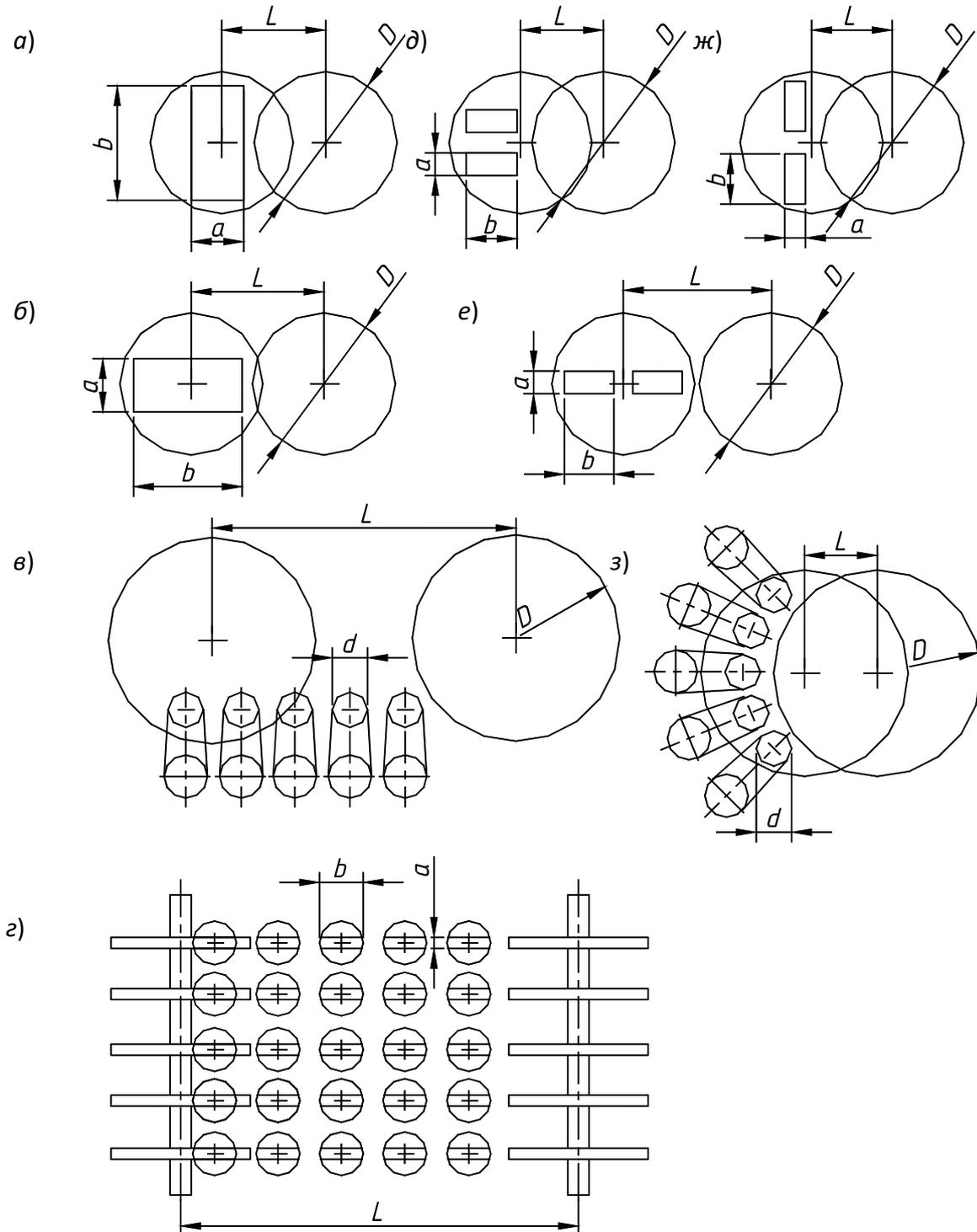
$a$ ,  $b$ ,  $d$  – размеры обрабатываемых поверхностей;  $D$  – диаметр фрезы;  $L$  – длина обработки
