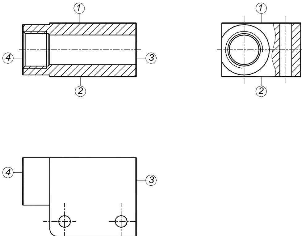
Рисунок 7.4 – Поверхности, требующие фрезерной обработки
