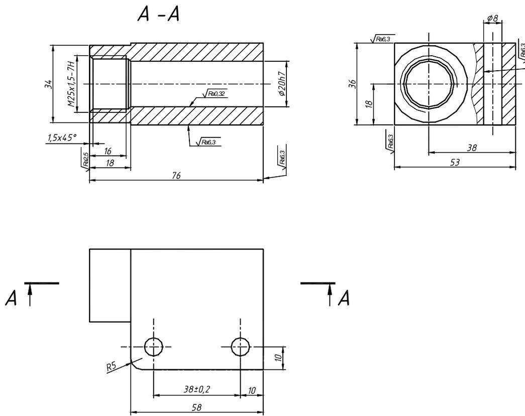
Рисунок 7.3 – Корпус гидронасоса
