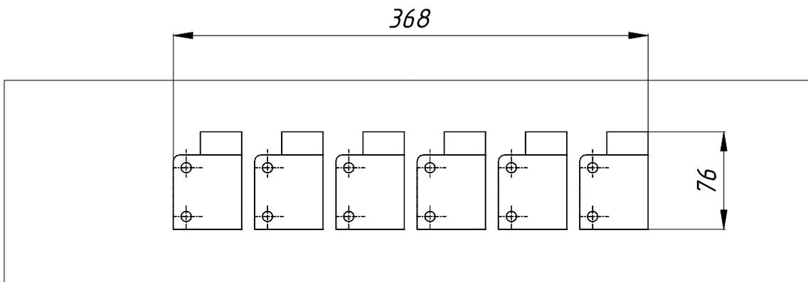
Рисунок 7.8 – Схема укладки заготовок на стол станка
