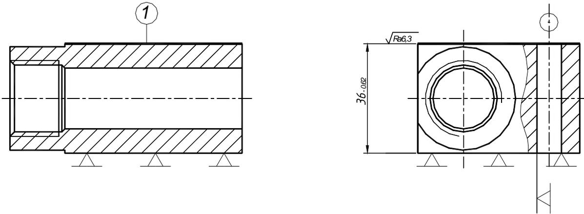
Рисунок 7.7 – Операционный эскиз фрезерования плоскости
