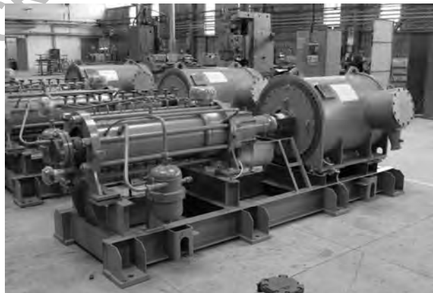
Рис. 5. Насосные агрегаты ГДМ8-03-125/700-400 для ОАО «Лукойл-Пермь»
