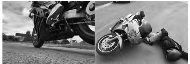
Рисунок 9 — Ситуации падения мотоциклов при торможении: а — кувырок мотоцикла через переднее колесо в результате отрыва заднего колеса от опорной поверхности; б — падение мотоцикла в результате бокового скольжения из-за снижения величины боковых сил
