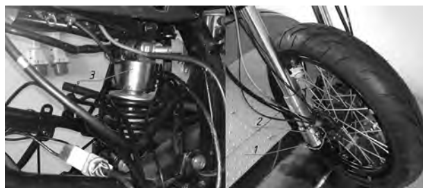
Рисунок 3 — Размещение датчиков измерения боковых сил и нормальной реакции опорной поверхности дорожного мотоцикла «Минск» CX200: 1 — датчик величины боковых сил; 2 — датчик нормальной нагрузки в пятне контакта переднего колеса; 3 — датчик нормальной нагрузки в пятне контакта заднего колеса
