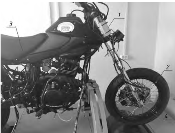
Рисунок 7 — Дорожный мотоцикл «Минск» на стенде испытаний тормозной динамики с размещенными на нем датчиками измерения сил: 1 — датчик угла поворота управляемого колеса; 2 — датчик нормальной нагрузки в пятне контакта переднего колеса с опорной поверхностью; 3 — датчик нормальной нагрузки в пятне контакта заднего колеса с опорной поверхностью; 4 — датчик величины боковых сил в пятне контакта колеса с опорной поверхностью
