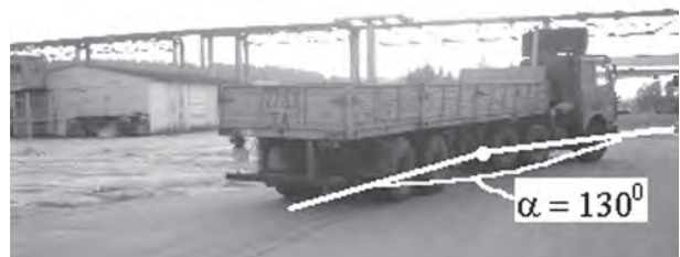
Рисунок 7 — Относительное положение звеньев АТС в конце торможения (управляемое торможение, начальная скорость торможения 70 км/ч, мокрый асфальт, R = 130 м)
