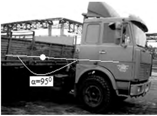
Рисунок 8 — Положение звеньев АТС при неуправляемом торможении по криволинейной траектории с отключенными тормозами полуприцепа
