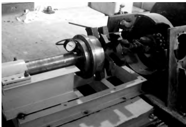
Рисунок 10 — Стенд испытаний дискового тормоза с развитой поверхностью трения фрикционных элементов
