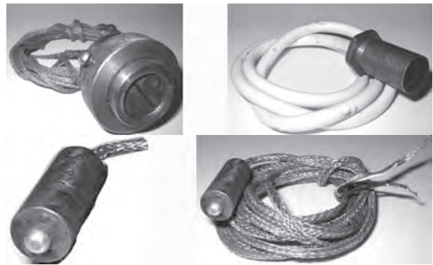
Рисунок 5 — Индукционные датчики измерения сил в тормозных механизмах
