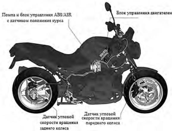
Рисунок 1 — Места размещения компонентов ПБС на мотоцикле [1]
