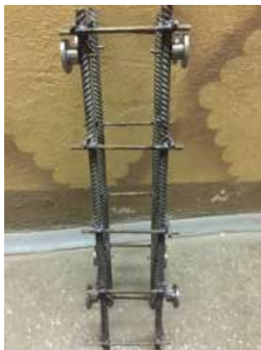
Рис. 5. Стальные переходные штуцеры в сварном каркасе
