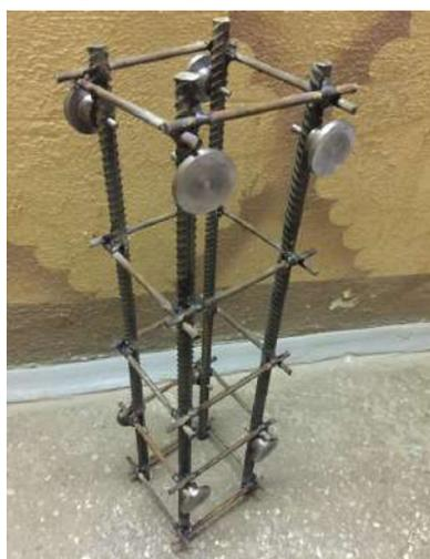
Рисунок 2 – Стальные переходные штуцеры в сварном каркасе
