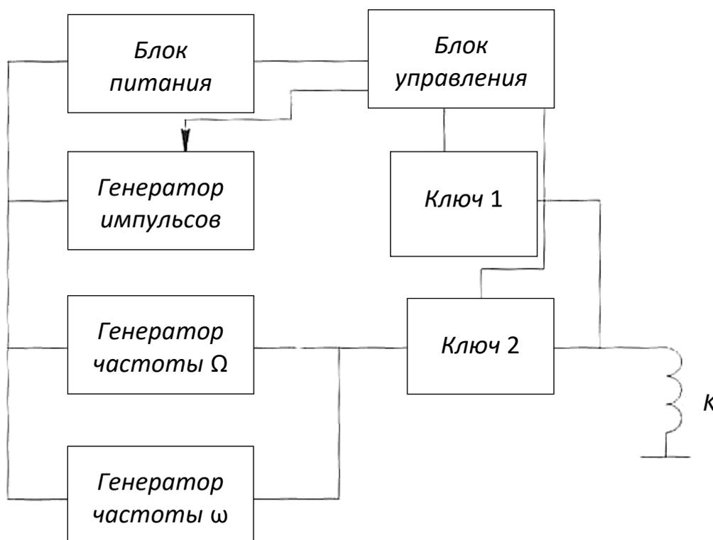
Рис. 3. Блок-схема устройства питания зондирующей катушки
