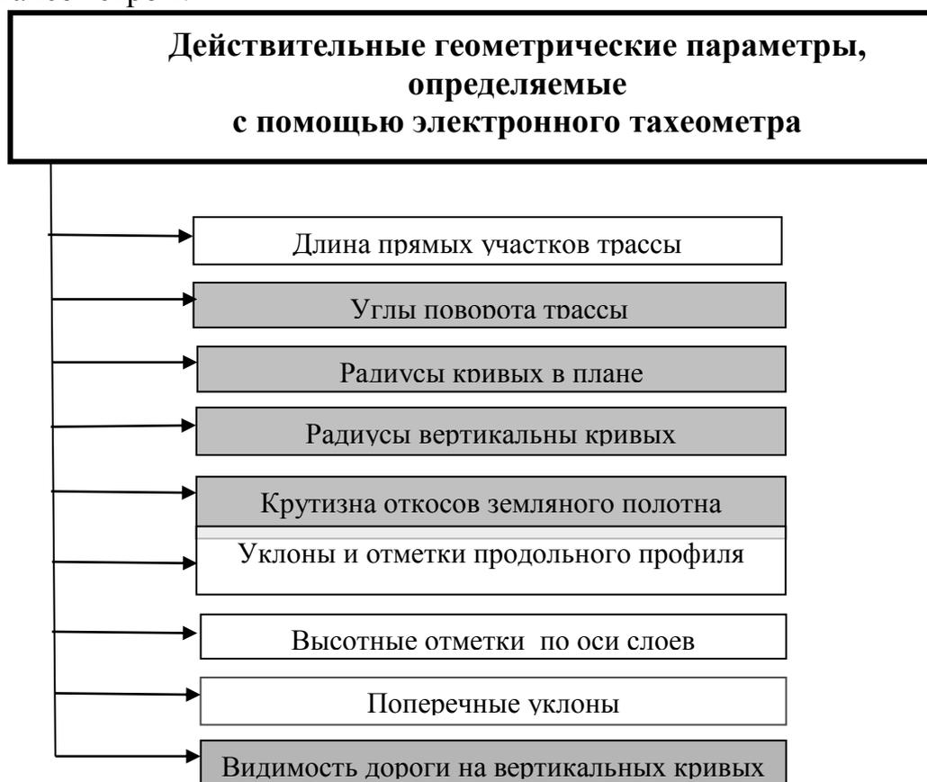
Разработаны способы и методики определения электронным тахеометром углов поворота трассы, радиусов кривых в плане и вертикальных кривых, крутизны откосов земляного полотна, видимости дороги на вертикальных кривых. Для радиусов кривых в плане и вертикальных кривых установлены условия применения разработанных способов и дана оценка их точности.
