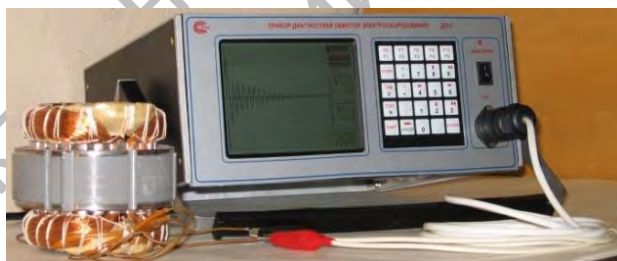
Рис. 1. Прибор ДО-1 для испытания обмоток электротехнического оборудования
