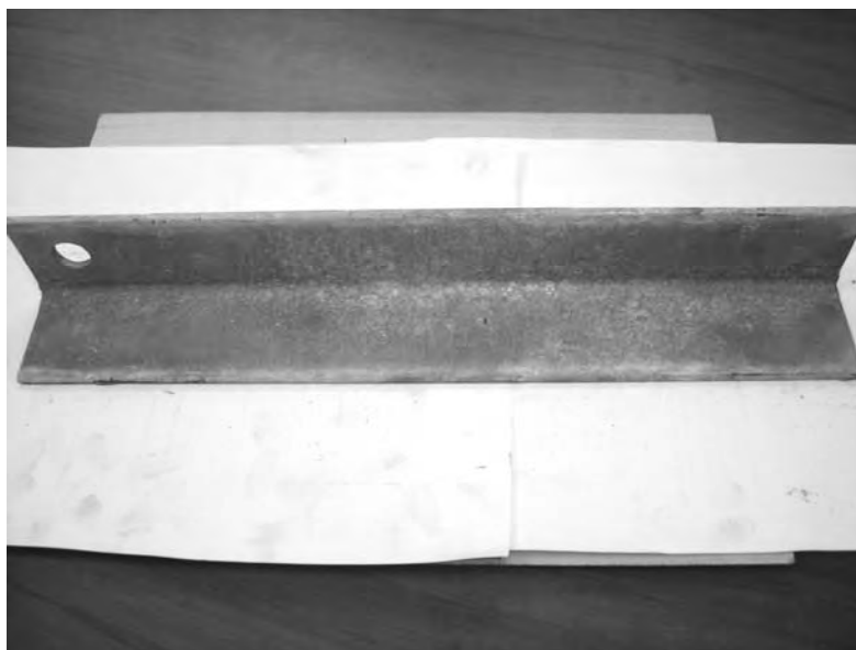
Рис. 2. Образцы после нанесения покрытия PROZINC PU PRIMER после проведения испытаний
