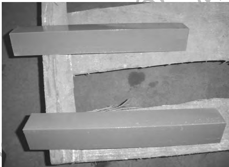
Рис. 1. Образцы после нанесения покрытия PROZINC PU PRIMER до начала испытаний
