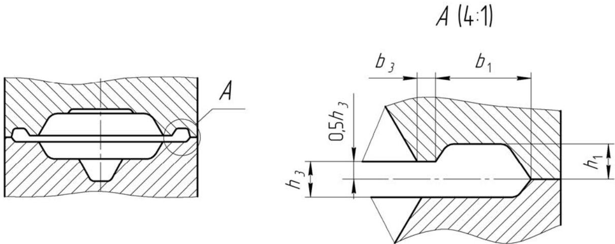
Рисунок 18 – Схема облойной канавки
