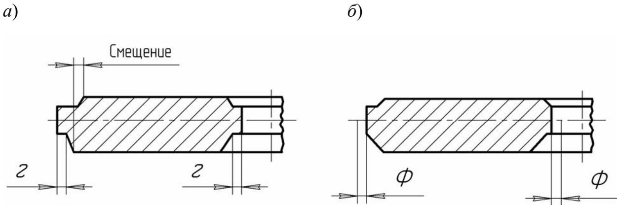
Рисунок 13 – Схема измерения остаточного обля (а) и срезанной кромки (б)
