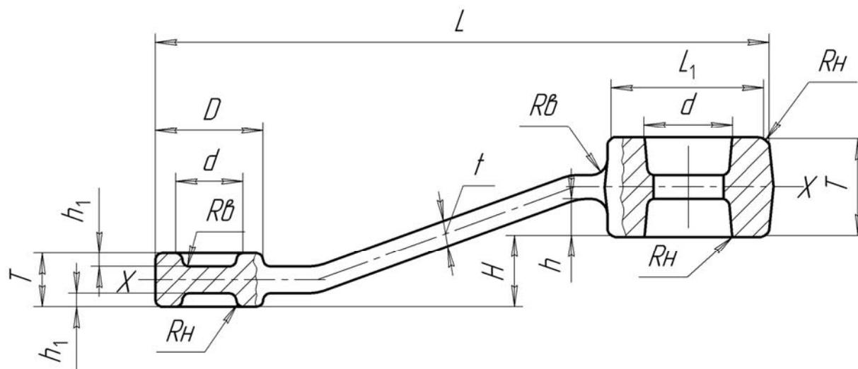
Рисунок 15 – Внешние и внутренние размеры поковки
