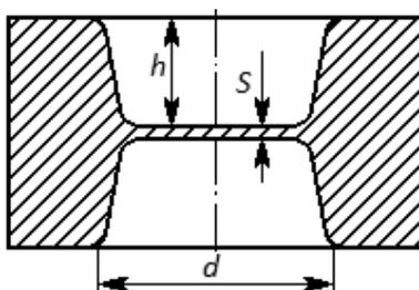
Рисунок 16 – Схема наметки отверстия
