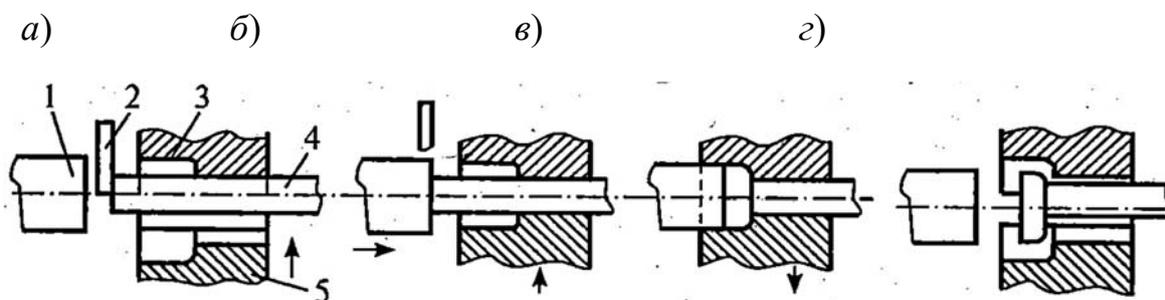
а – подача заготовки; б – смыкание матриц; в – штамповка; г – размыкание матриц; 1 – пуансон; 2 – упор; 3 – неподвижная часть матрицы; 4 – пруток; 5 – подвижная часть матрицы
