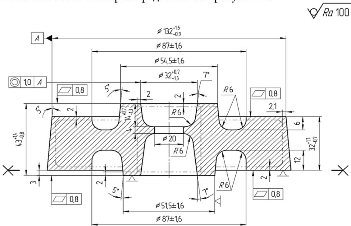
Рисунок 22 – Эскиз поковки, штампуемой в закрытом штампе
