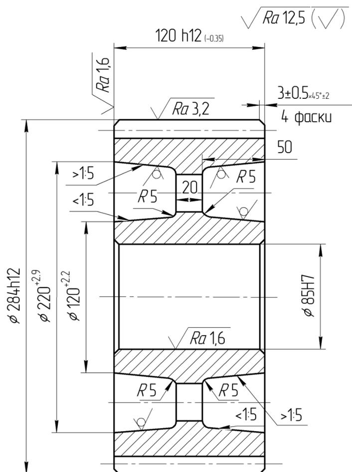
Рисунок 23 – Эскиз зубчатого колеса
