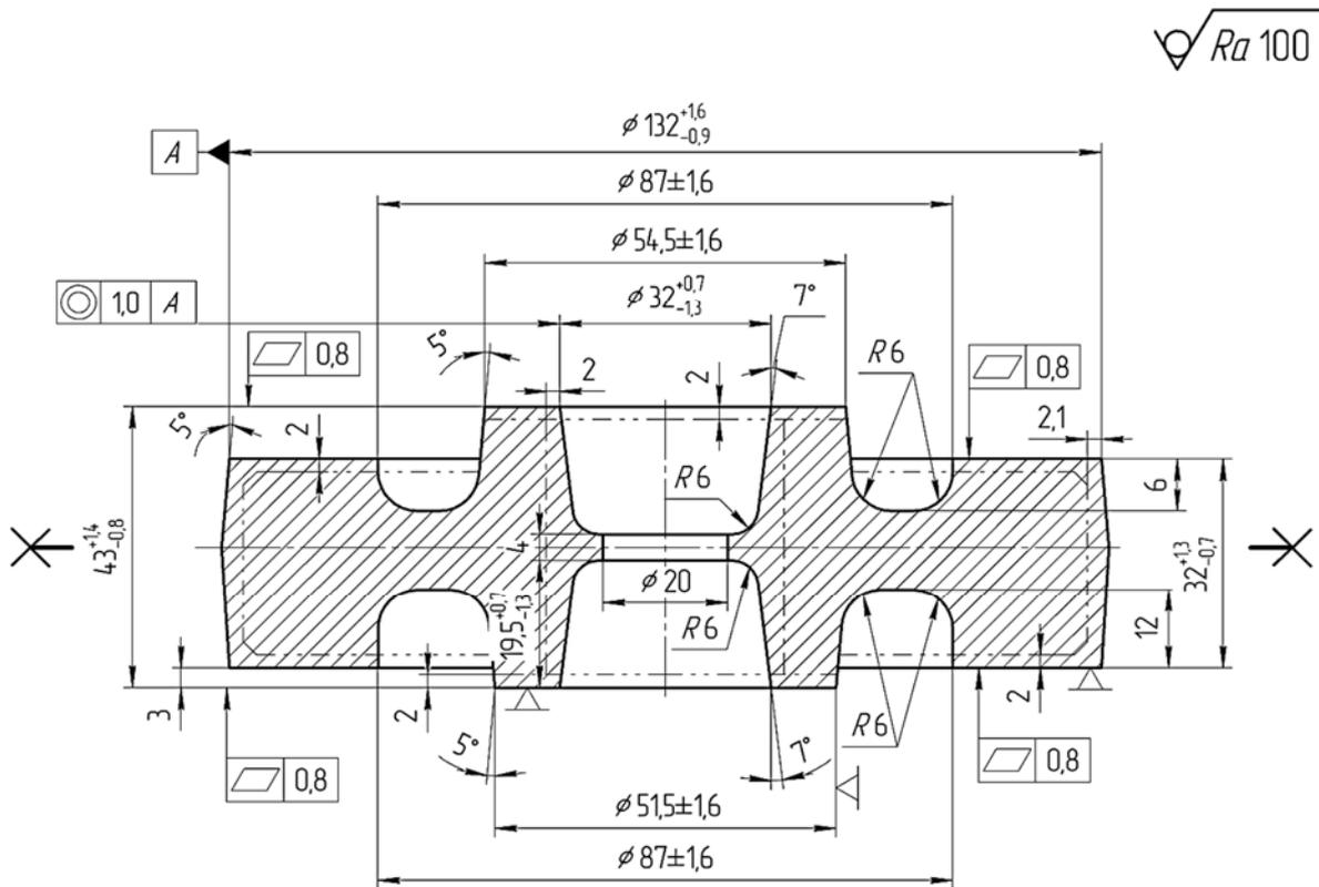
Рисунок 21 – Эскиз поковки, штампуемой в открытом штампе
