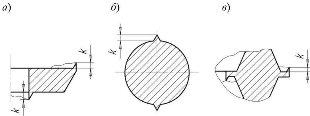
Рисунок 14 – Схема к определению заусенца
