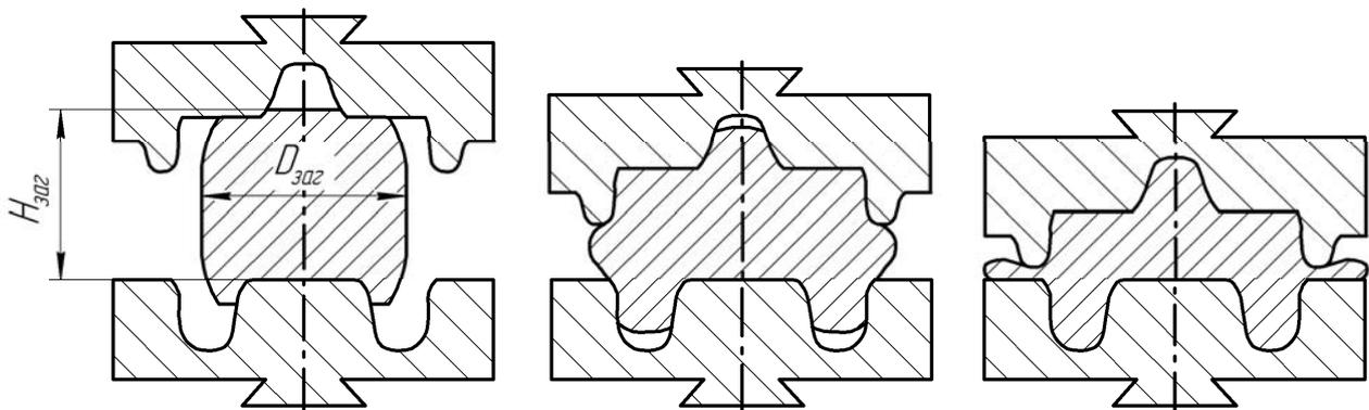
Рисунок 19 – Пример формообразования поковки из исходной заготовки
