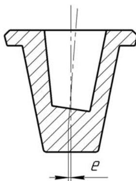
Рисунок 11 – Схема к определению отклонения от соосности
