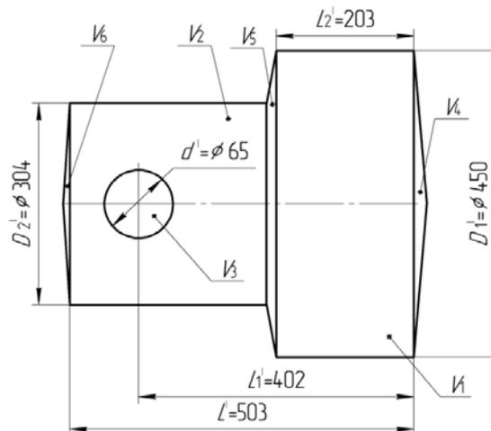
Рисунок 3 – Расчетная схема заготовки
