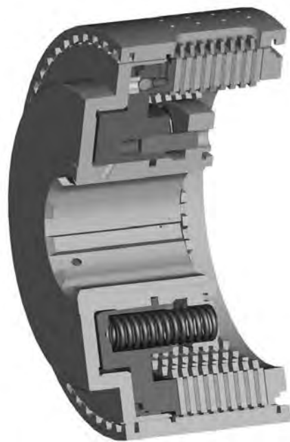
Рис. 2. Конструкция фрикциона ГМП с МСАУ
