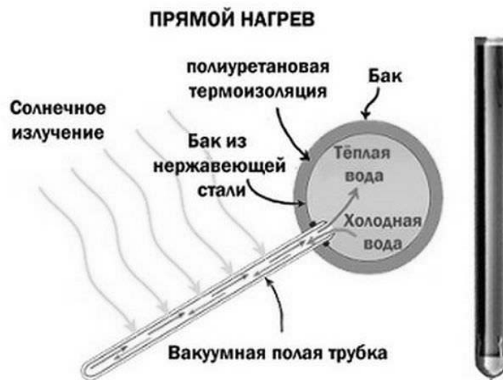
Рисунок 8.3 – Схема работы вакуумного коллектора с прямой теплопередачей воде
