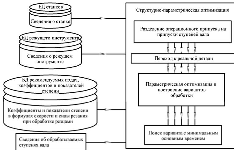
**Рисунок 1. – Схема автоматизации расчётов для структурно-параметрической оптимизации наружного продольного точения цилиндрических поверхностей ступенчатых валов**
