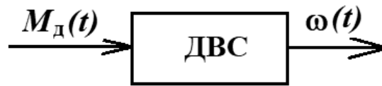
Рис. 2. Двигатель внутреннего сгорания как функциональный элемент системы автоматического управления скоростью движения автомобиля
