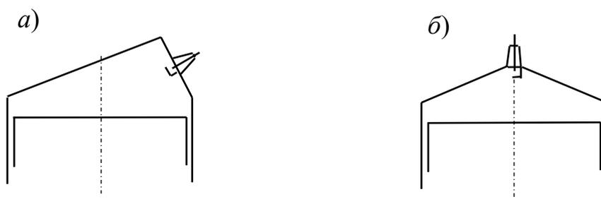
Рис. 3.29. Типовые камеры сгорания моторов с принудительным воспламенением: а – ВАЗ-2101; б – Yamaha FZR1000
