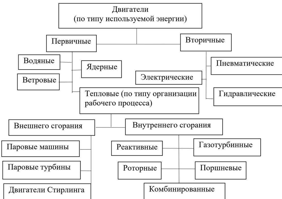
Рис. 1.3. Классификация двигателей
