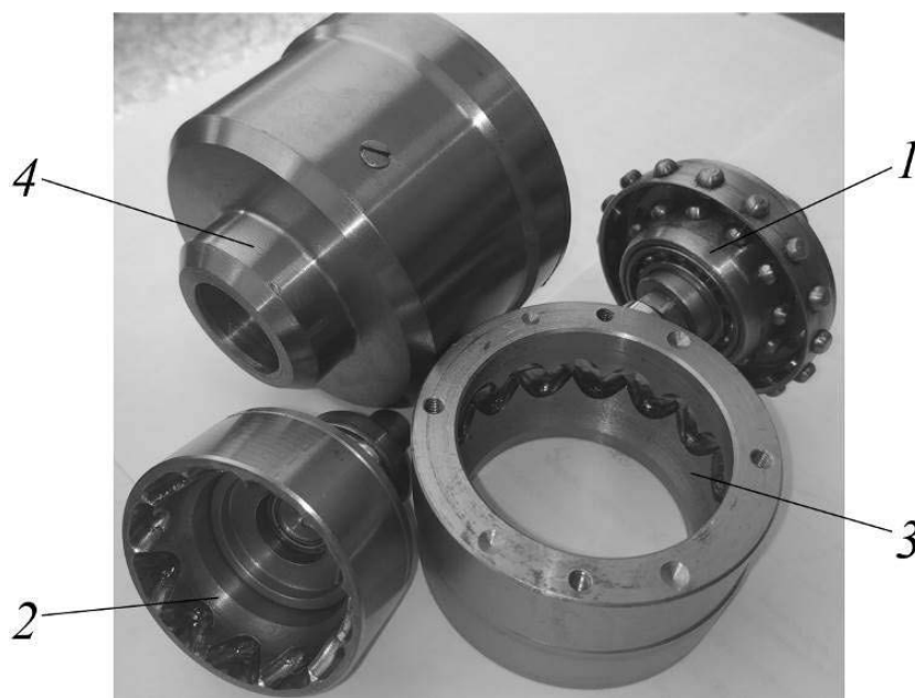
Рис. 2. Основные узлы изготовленного редуктора на основе СРП: 1 – ведущий вал с установленным на нем сателлитом; 2 – ведомый вал с ведомым кулачком; 3 – два остановленных кулачка, образующих неподвижную беговую дорожку; 4 – корпус редуктора
