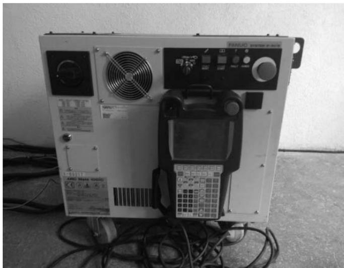
Рисунок 9.9 – Контроллер с пультом управления робота FANUC Robot ARC Mate 100iC
