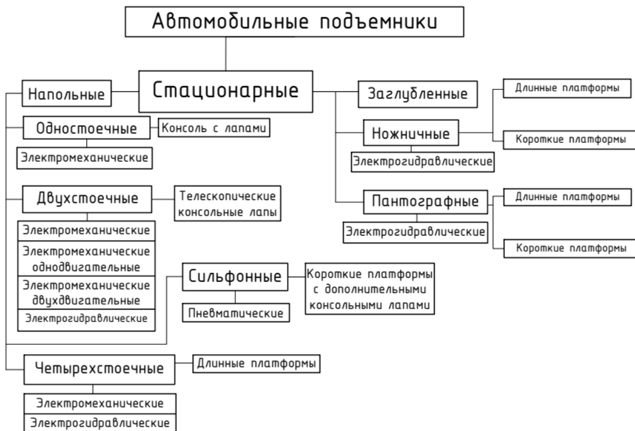
Рисунок А.6 – Схема классификации подъемно-транспортного оборудования для зоны ТО и ТР ОАС [4]
