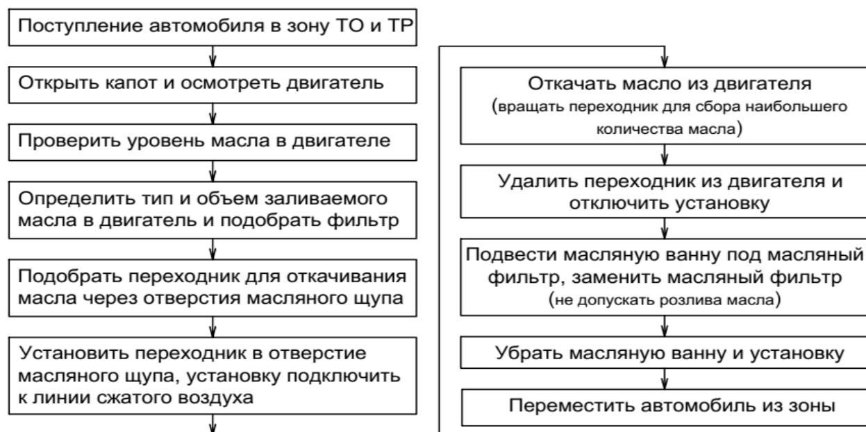
Рисунок А.10 – Схема технологического процесса на замену масла в ДВС автомобиля через отверстие маслосборного щупа
