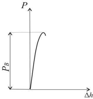
Рисунок 4.6 – Опытная диаграмма сжатия образца
