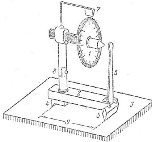
1 – лимб винта; 2 – планка; 3 – образец; 4 – неподвижная опора; 5 – подвижная опора (призма); 6 – рычаг; 7 – указатель отсчета; 8 – стойка
