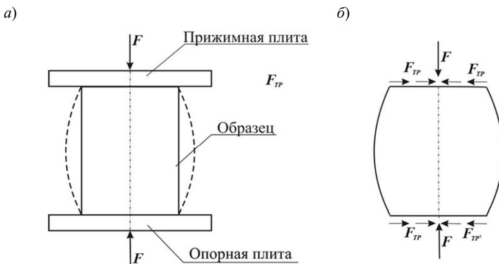
Рисунок 4.2 – Характер деформирования и нагрузки, действующие на образец
