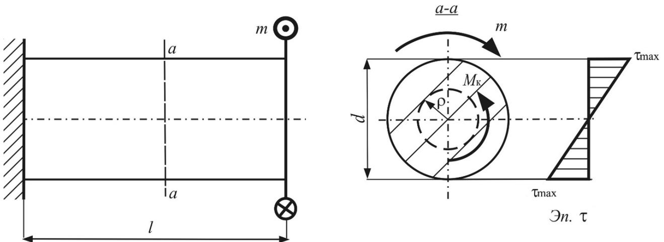
Рисунок 5. 1 – Схема нагружения и эпюра касательных напряжений
