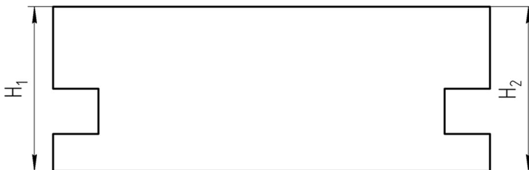
Рисунок 2.4 – Схема измерения образцов
