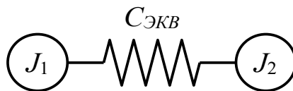
Рисунок 10 – Двухмассовая консервативная расчётная схема механической части ЭП
