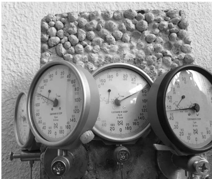
Рис. 1. Опытный образец для определения деформаций усадки керамзитожелезобетона
