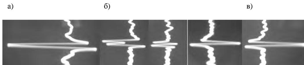
Рис. 1. Трансформация сигнала, обусловленного дефектом, при намагничивании объекта перпендикулярно поверхности перемещаемым постоянным магнитом с близкорасположенными полюсными гранями: а – расстояние  $\Delta$  от полюса магнита до объекта 0,2 мм; б –  $1,75 \leq \Delta \leq 2,25$  мм; в –  $\Delta = 4$  мм
