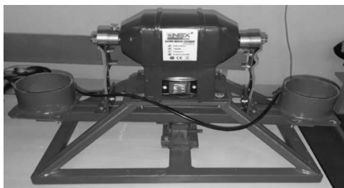
Рис. 1. Вертикальная вибрационная мельница для сверхтонкого помола ( а ) и сменные эксцентрики ( б ), используемые в эксперименте
