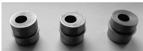
Рис. 1. Вертикальная вибрационная мельница для сверхтонкого помола ( а ) и сменные эксцентрики ( б ), используемые в эксперименте
