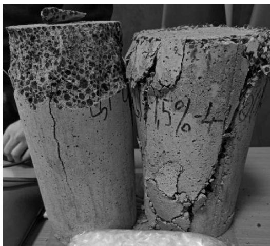
Рис. 1. Разрушенные опытные цилиндры: из неармированного керамзитобетона (слева) и керамзитофибробетона, армированного полипропиленовой фиброй (справа)
