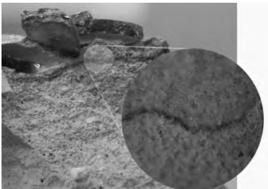
Рис. 1. Фотография среза образца с оплавленным декоративным слоем на его поверхности после пропитки (фрагмент увеличен в 49 раз)
