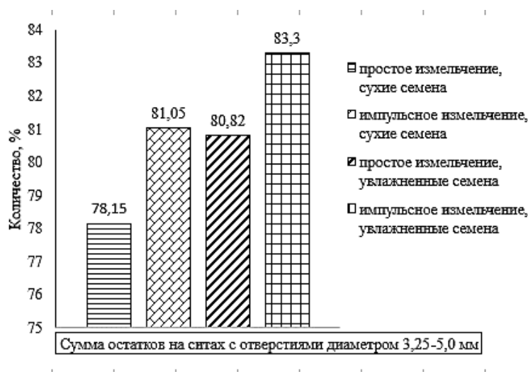
Рис. 1. Суммарное распределение продуктов измельчения семян гороха сорта Миллениум на ситах с отверстиями диаметром 3,25...5,0 мм
