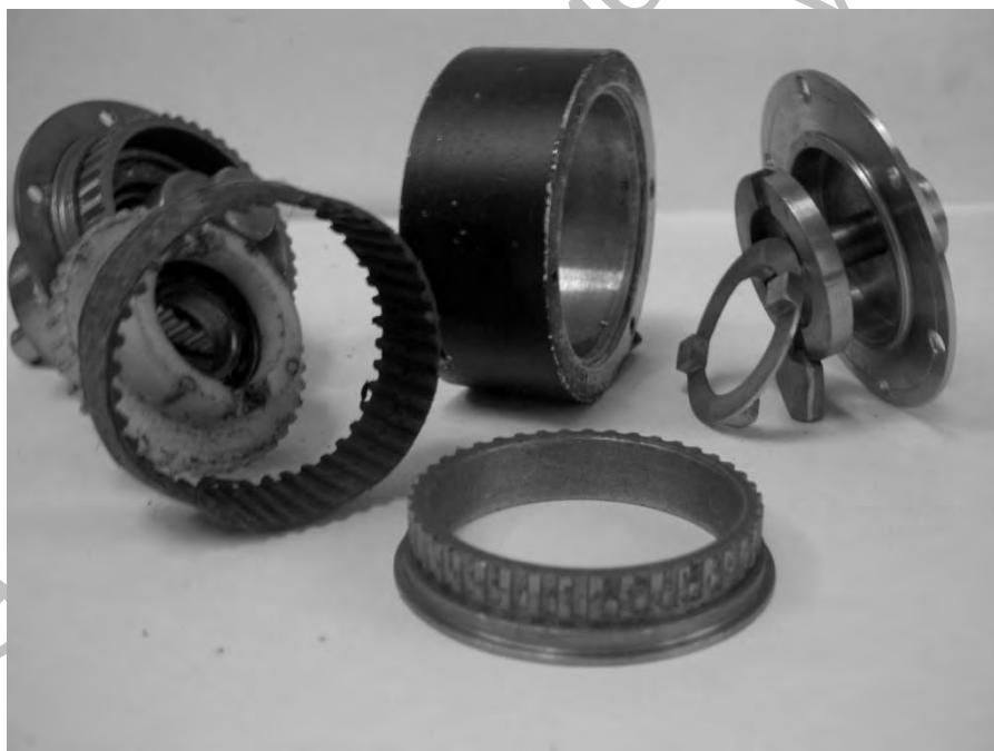
Рис. 3. Детали макета зубчато-ременного планетарного механизма с полимерным ремнем
