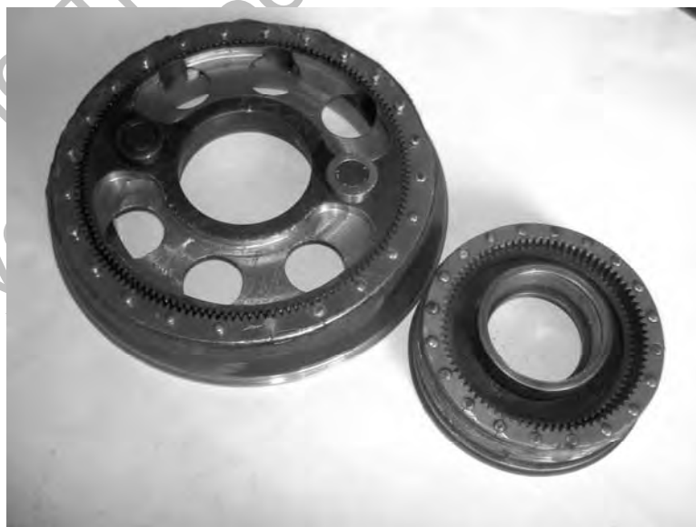
Рис. 5. Две сборки зубчатых цепей с неподвижным колесом и сателлитом с числами зубьев цепей 142 и 82 и модулем 1 мм
