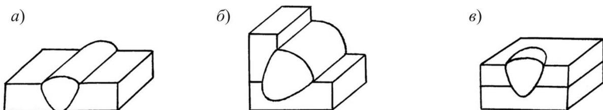
*а* – стыковой; *б* – угловой; *в* – прорезной
