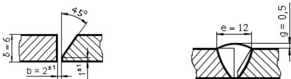
Рисунок 2.1 – Эскиз сварного соединения
