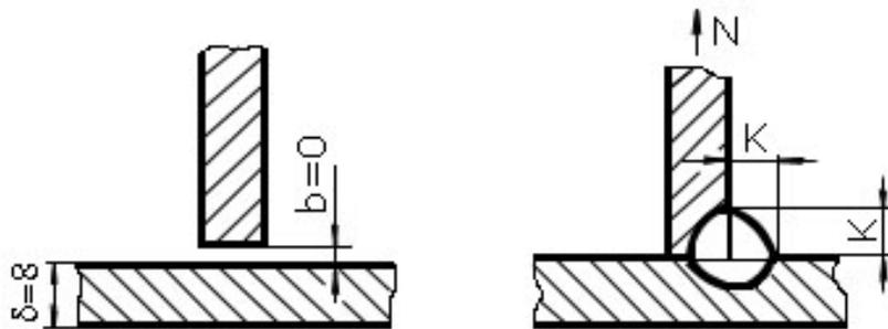
Рисунок 2.3 – Эскиз сварного соединения
