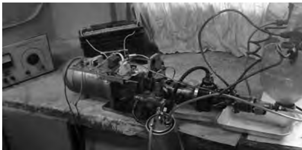
Рис. 4. Стенд для испытаний первого опытного образца ТНВД
