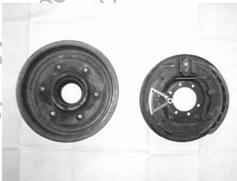
Рис. 4. Макетный образец колодки, обеспечивающий равномерное облегание фрикционной оболочки колодки барабанного тормоза к поверхности барабана
