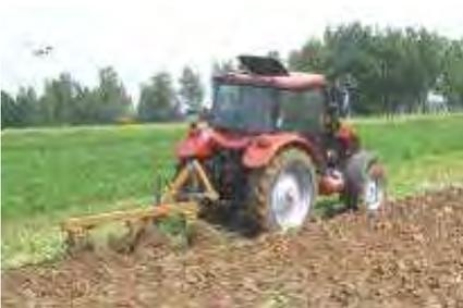
**Рисунок 13. – Работа МТА «Беларус-922» + ПЛН-3-35 с подачей газового топлива**
