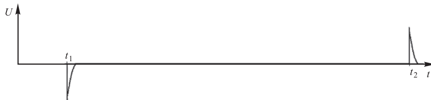
Рис. 5. Импульсы напряжения на выходе второй дифференцирующей цепи при перемещении кузова в процессе торможения автомобиля
