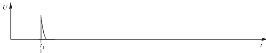
Рис. 4. Положительный импульс напряжения на выходе первой дифференцирующей цепи с отсекающим диодом
