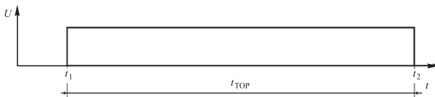
Рис. 2. Напряжение на выходе преобразователя импульсного щелевого датчика перемещения педали
