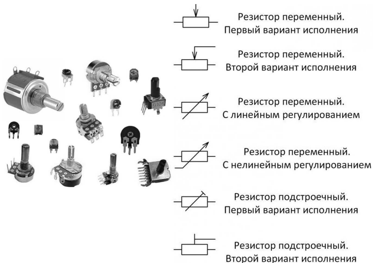
Рисунок 1.2 – Переменные резисторы и варианты их исполнения
