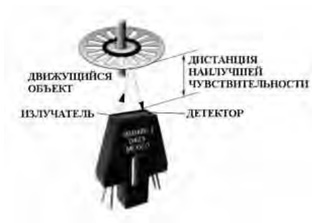
Рис. 3. Принцип работы оптического датчика скорости, работающего по методу отражения
