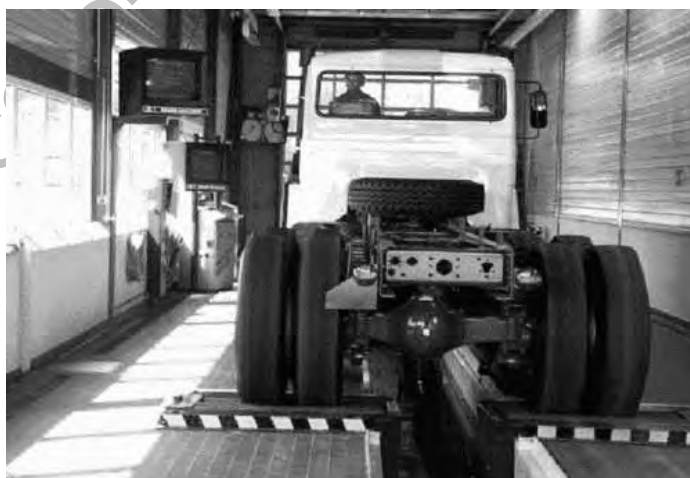
Рис. 1. Роликовый тормозной стэнд для грузовых автомобилей с максимальной нагрузкой на ось до 18 т IW 7/E немецкой фирмы «МАНА»
