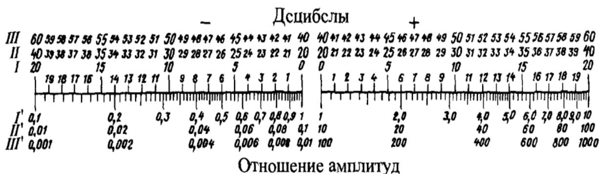
Рисунок 3.1 – Шкалы перевода относительных величин в децибелы. Попарно используют шкалы I-I', II-II', III-III'
