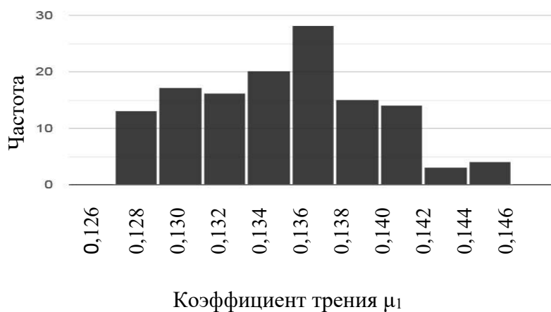
Рис. 8. Гистограмма распределения коэффициента трения \mu_1 колодки по смазанной направляющей
