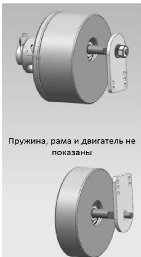
Рис. 3. Приспособление для ускоренных испытаний пружин
