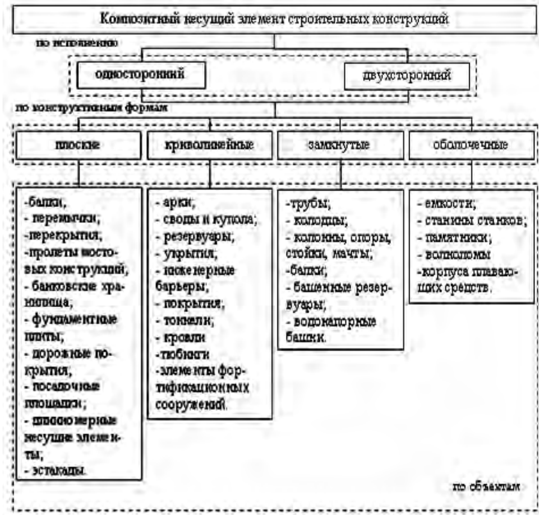
Рис. 2. Классификация КНЭСК по конструктивным формам
