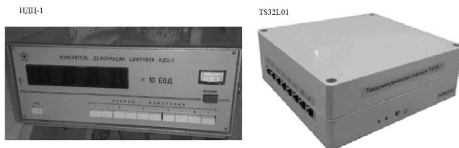
Рисунок 1.11 – Измеритель деформаций цифровой ИДЦ-1 и тензостанция TS32L01
