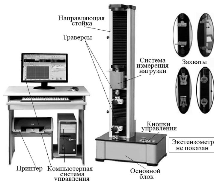
Рисунок 2.1 – Общий вид испытательной машины Kason WDW-1
