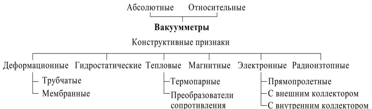
Рисунок 1.1 – Классификация вакуумметров для измерения общих давлений
