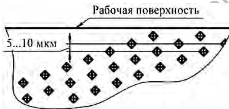
Рис. 1. Схема измерения микротвердости по глубине
